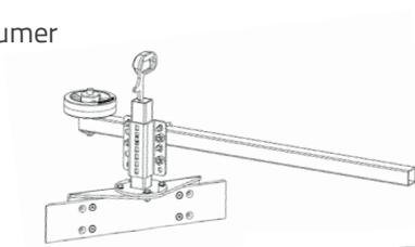
Zugentlastung mit Gasdruckdämpfern
