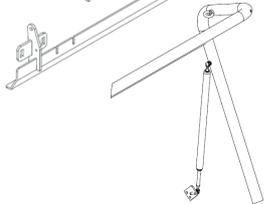
Zugentlastung mit Gasdruckdämpfern
