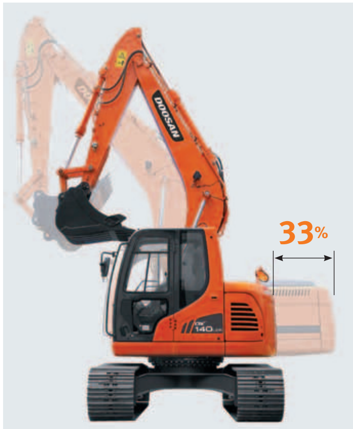
Dépassement de la cabine sur le châssis entre 15,5 et 23,5 cm.
